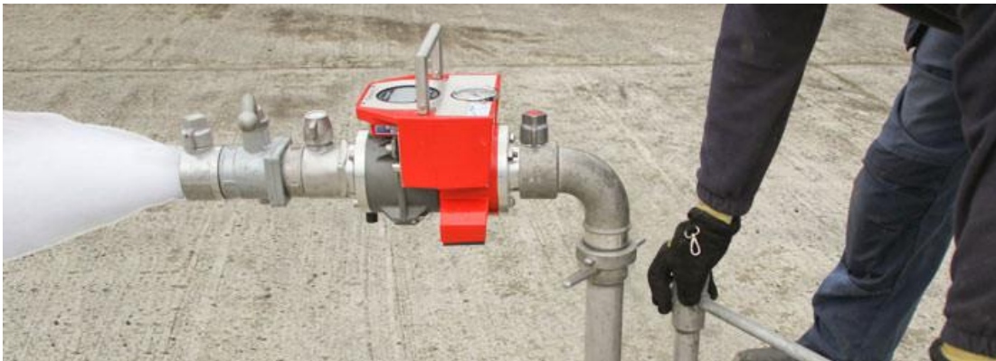
Slika 8. Mjerenje pomoću posebnog mjerača s elektromagnetnim senzorom Figure 8. Measurement with special electromagnetic flow meter
