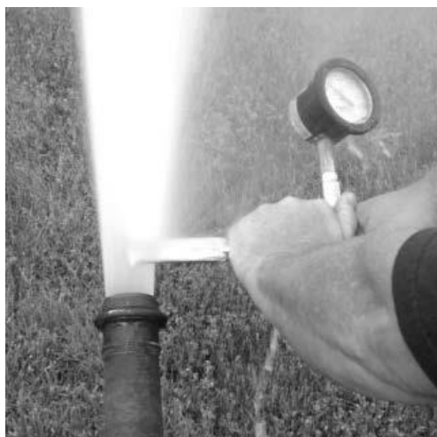
Slika 6. Mjerenje kinematičkog tlaka pomoću Pitot cijevi
