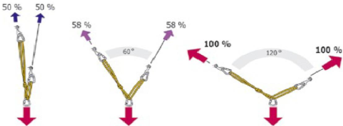
Slika: Raspored opterećenja po sidrišnim točkama (Izvor: [www.petzl.com](http://www.petzl.com))
